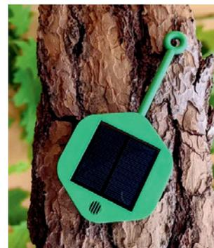
Abb. 7: Sensor (Quelle: <https://de.dryad.net/wildfiresensor>)
